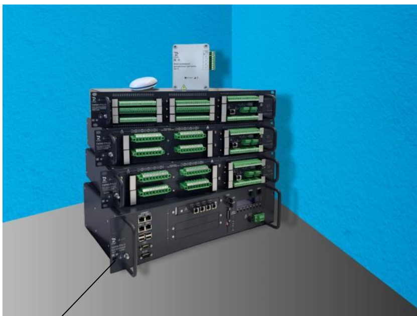
Рисунок 3 - Общий вид регистраторов «Исполнение 2» (в составе с блоком регистрации высотой 3U) с указанием места нанесения знака утверждения типа и заводского номера
