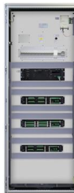
Рисунок 3 - Общий вид регистраторов «Исполнение 2» (в составе с блоком регистрации высотой 3U) с указанием места нанесения знака утверждения типа и заводского номера
